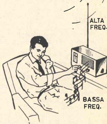
Il principio delle radiotrasmissioni è illustrato chiaramente in questo disegno. La voce umana, captata dal microfono, viene trasformata in onde radio, che si irradiano nello spazio attraverso l'antenna trasmittente. L'apparecchio radio capta le onde e le converte in voci e suoni.
